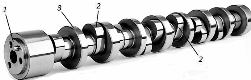
Fig. 4.72. Ax cu came: 1- cap fixare roată acționare; 2- came profilate; 3- fus
