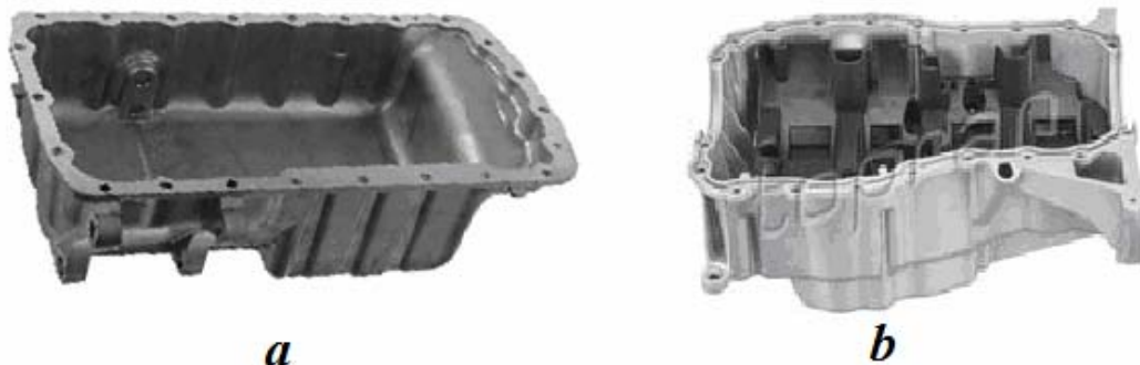
Fig. 4.62. Baie de ulei turnată din aluminiu
