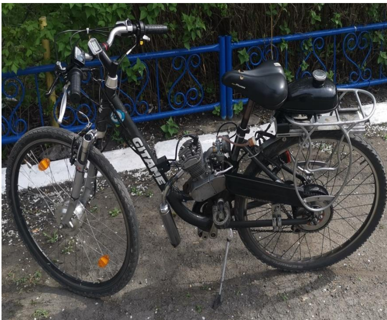
Fig. 3. Bicicletă hibridă, cu două surse de energie suplimentară, electrică și cu motor termic.
