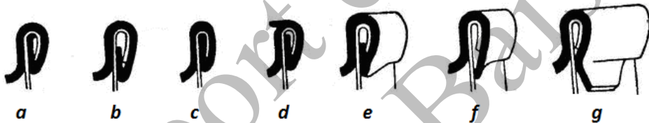
Fig. 4.56. Forme ale falțului dublu: a- normal; b- înalt; c- prea strâns; d- cu creastă; e- cu limbă; f- cu dinte; g- cu buză
