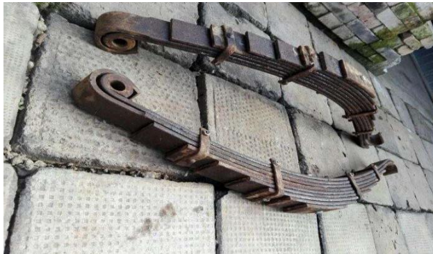
Arc cu foi multiple : 1—foaie principală ; 2—foaie principală de întărire ; 3 — foi secundare ; 4 — legătură de arc ; 5—adaosuri
