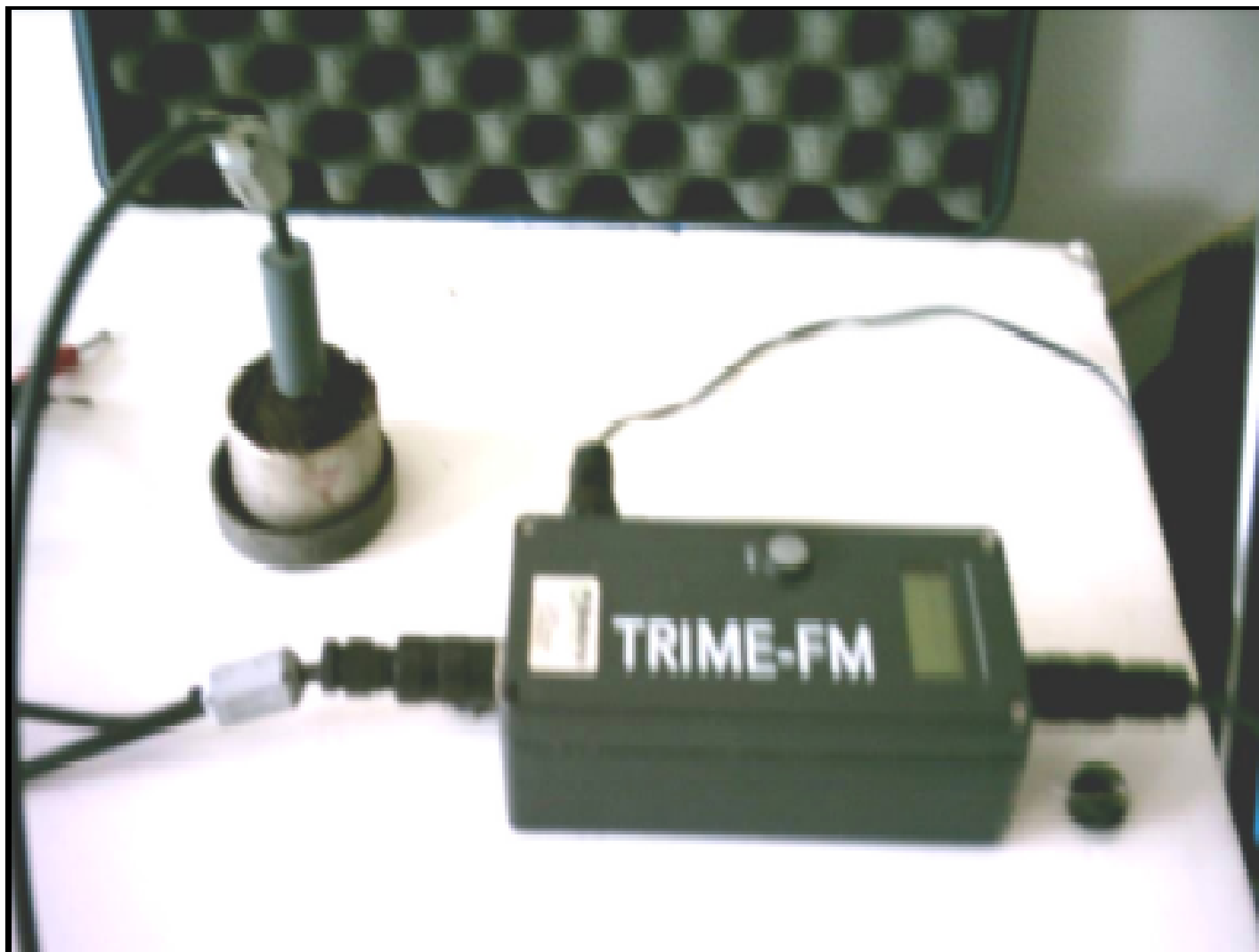
Fig. 1. Aparatul Trime-FM pentru măsurarea umidității solului (IMKO GmbH., Ettlingen, Germania), având cuplate traductorul de umiditate, cablul pentru comunicația serială cu calculatorul și cablul de alimentare.
