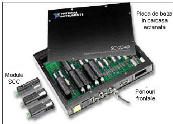
Figura @.8: Sistem de condiționare SCC
