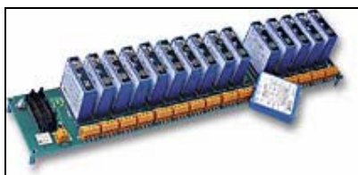
Figura @.7: Sistem de condiționatoare 5B
