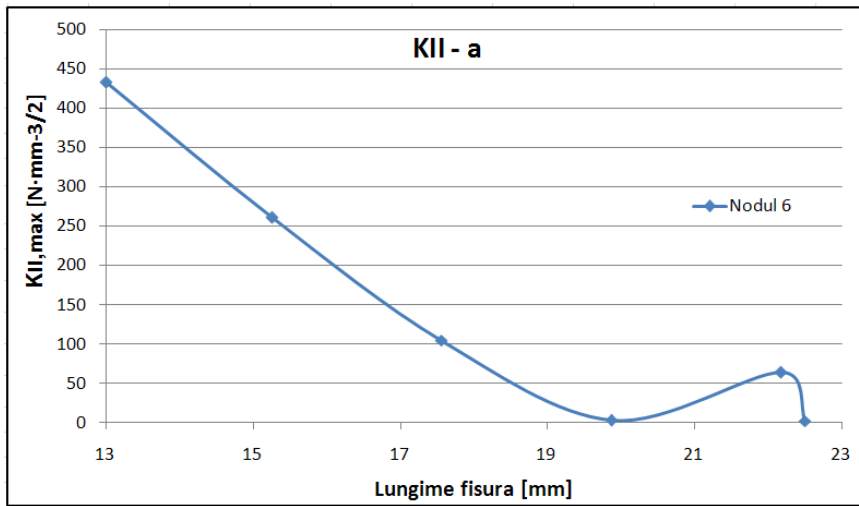
Fig. 10.17. Variația K_{II} în raport cu lungimea fisurii – modul II
