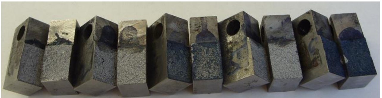
Fig. 4.17. Probe rupte prin încercarea K_{Ic} din șina '85
