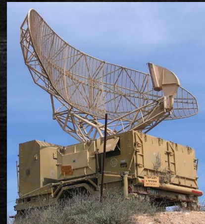
Radar de tipul utilizat pentru detectarea aeronavelor. Se rotește constant, mătură spațiul aerian cu un fascicul îngust.
