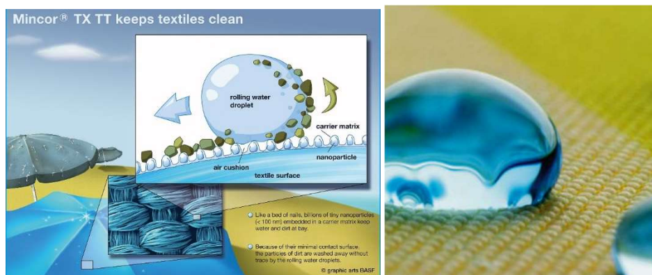
Figura 26. Tratament de suprafață pentru textile cu auto-curățare (BASF Company)
