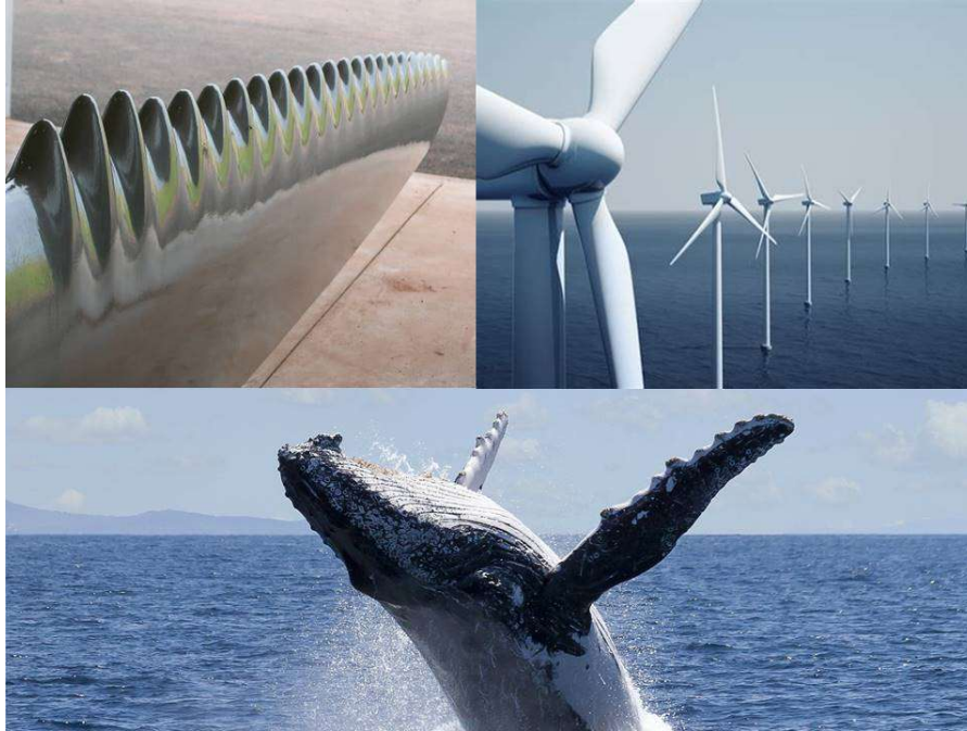
Figura 20. Prototip de pală de eoliană testată de către WhalePower pe insula Prince Edward (Taylor, 2008)
