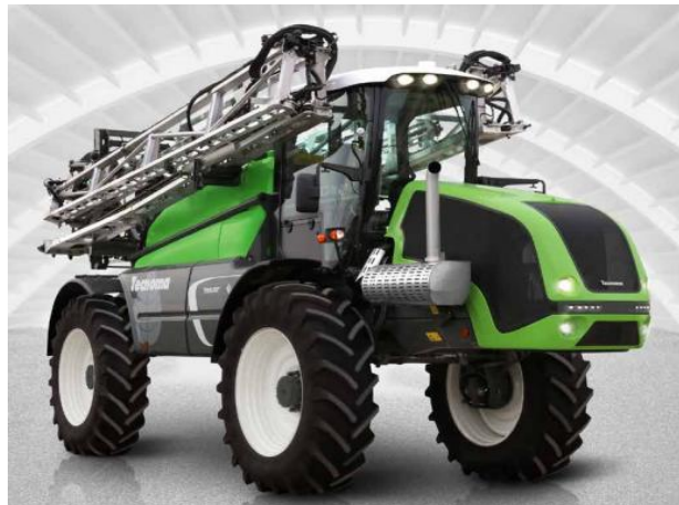
Fig. 12.5 – Mașină autopropulsată pentru administrarea tratamentelor fitosanitare, model Laser 5200, produsă de firma Technoma, Franța
