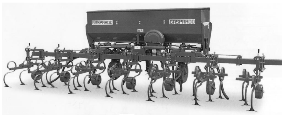
Fig. 6.8 – Cultivator prășitor cu distribuirea de îngrășămintă pe sol
