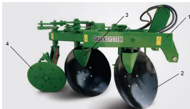
Fig. 3.10. Plug cu discuri purtat pe tractor: 1 - cadru; 2 - cormană tip disc; 3 - răzuitori; 4 - plaz
