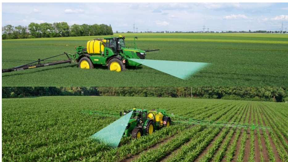
Fig. 12.6 – Sistemul AutoTrac Vision montat pe mașinile de stropit produse de firma John Deere
