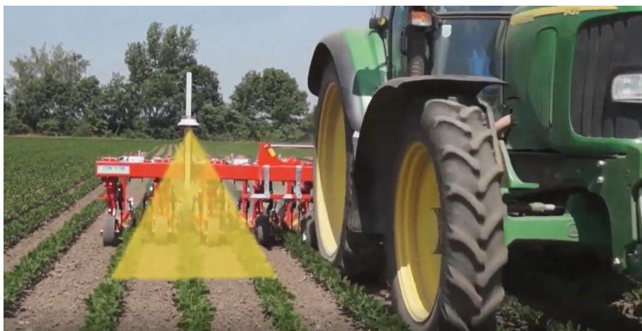
Fig. 6.15 – Sistem montat pe cultivator cu cameră video cu lentilă dublă
