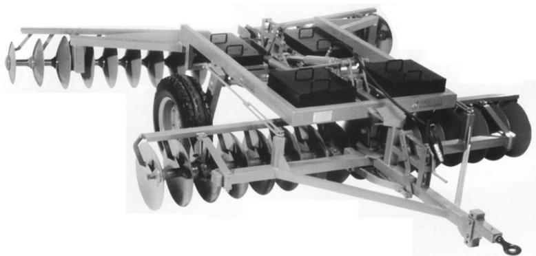
Fig. 5.18 – Grapă cu discuri cu greutateți de lestone
