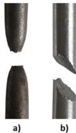
Fig. 2.3. Rupere ductilă (a) și fragilă (b)
